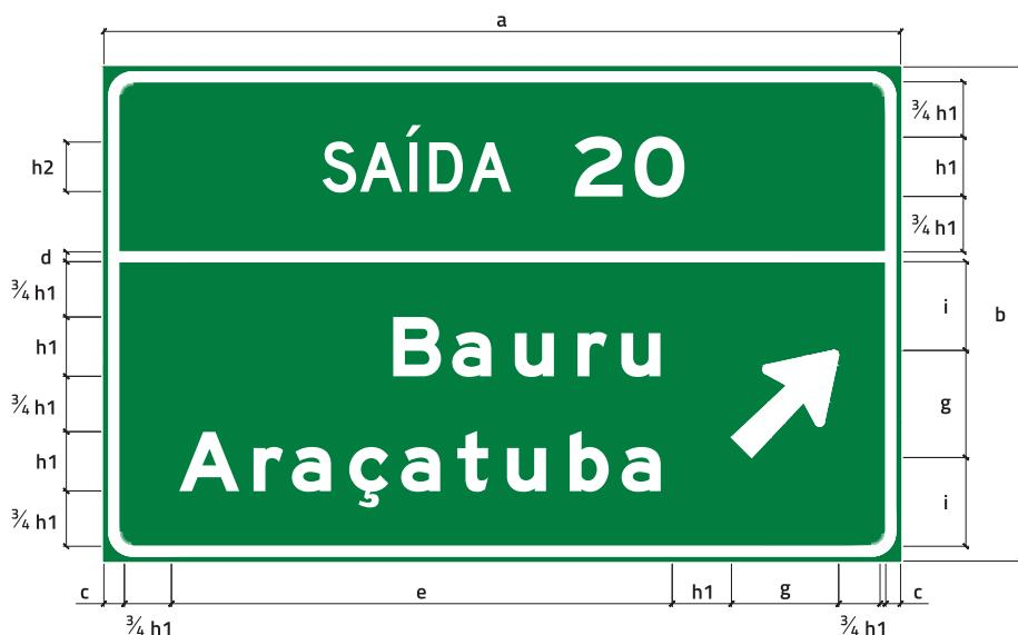
As dimensões externas da placa, **a** e **b**, são obtidas da seguinte forma:
